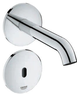
36 447 000 Infrarot-Waschtisch-Armatur (230 V) ohne Mischeinrichtung Ausladung 182 mm
